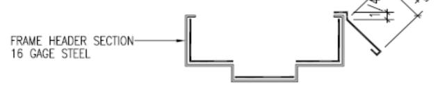
DETAIL # 3A - PLASTER WALL CONDITION DETAIL FOR EXTERIOR DOOR WHERE RAIN DRIP IS REQUIRED. EXTERIOR SIDE WITH 22 GAGE GLAVANIZED SHEET METAL OR PAINT LOCK RAIN DRIP WELDED IN PLACE.
